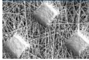
شكل (1) يوضح شبكة الألياف الغير منسوجة بطريقة ال SpunBond (12)
