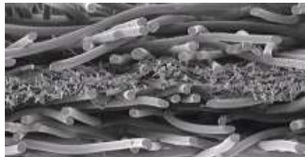
شكل (5) يوضح طبقات قماش ال SMS (16)
