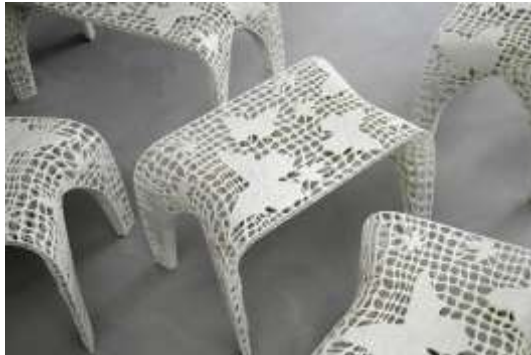
(شكل رقم 11) يظهر من الشكل كيف تستطيع ماكينة الطباعة ثلاثية الابعاد ان تنتج منتج فراغي مجوف مع الاحتفاظ بالمتانة المطلوبة
