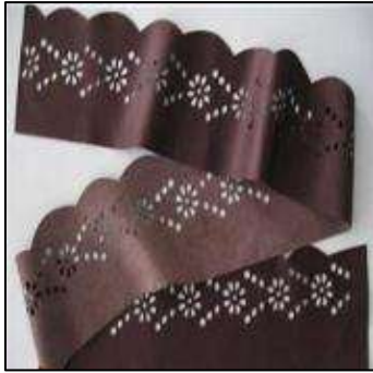
صورة رقم (80) قص بالتقطيع والثقب بالليزر
