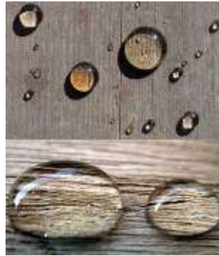
( صورة 6 ) سطح الخشب المعالج بطبقة من طلاء النانو الطارد للمياه
