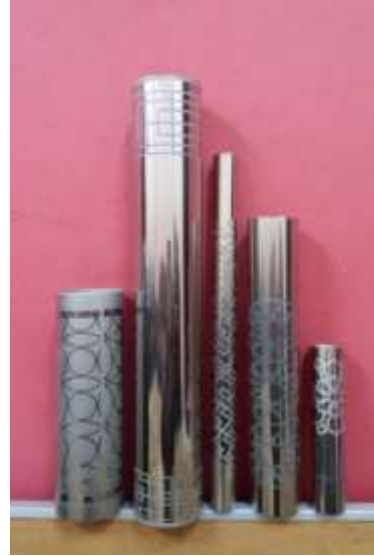
شكل ( 11 ) نتائج بعض التجارب الأخرى للحفر الكهروكيميائي العميق
