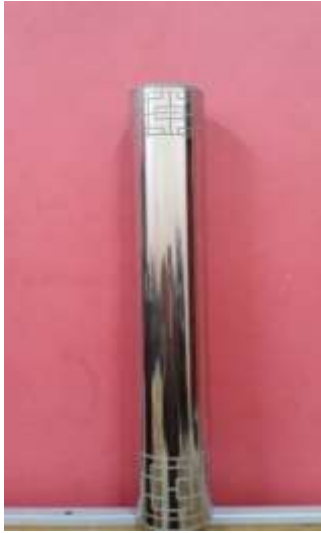
شكل ( 10 ) العينة بعد انتهاء عملية الحفر الكهروكيميائي
