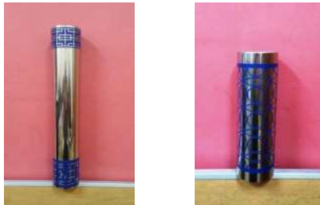
شكل ( 9 ) العينة بعد إزالة المادة العازلة من المساحات المراد حفرها
