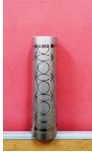
شكل ( 10 ) العينة بعد انتهاء عملية الحفر الكهروكيميائي
