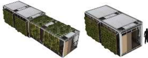
شكل (4) الوحدة المتطورة فى كل من حالتها الأصلية وحالتها بعد التمدد.
